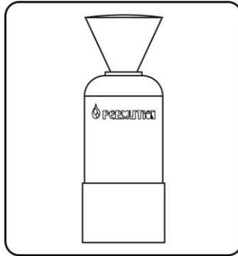
**8º)** Com o auxílio de um cone coloque o novo Elemento Filtrante dentro da Coluna PermutiON.
