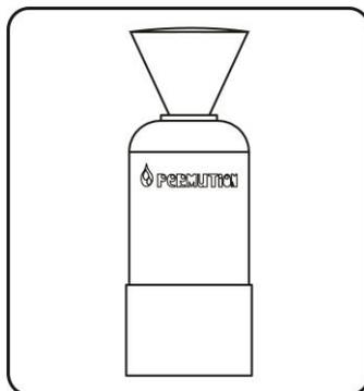
**8º)** Com o auxílio de um cone coloque o novo Elemento Filtrante dentro da Coluna Permutation.
