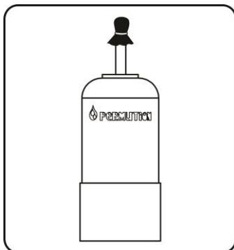
**7º)** Coloque novamente o varão de PVC dentro da Coluna Permutation.
