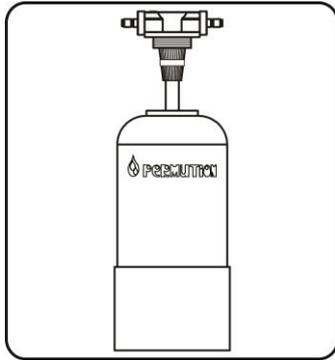
**10º)** Conecte o cabeçote ao varão de PVC para formar o sistema hidráulico novamente.
