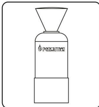
**8º)** Com o auxílio de um cone coloque o novo Elemento Filtrante dentro da Coluna Permutiion.
