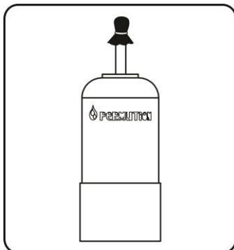
**7º)** Coloque novamente o varão de PVC dentro da Coluna Permutiion.
