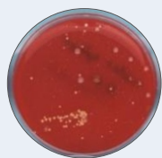
Cultura em placa após 72 h, água produzida por osmose reversa e estocada em tanque.
